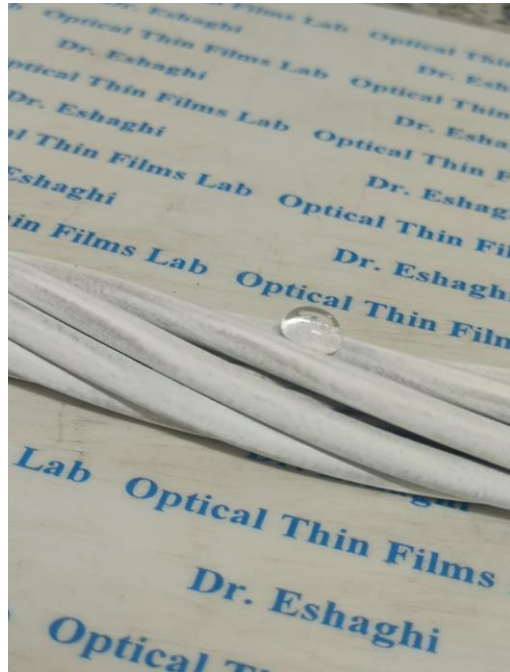
تصویر قطره آب روی سطح هادی هوایی پوشش دهی شده
